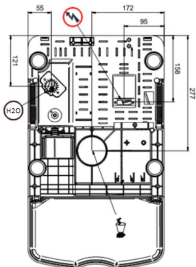
Tischausschnitt für Wasser- und Stromleitungen: ca. 70 mm Durchmesser
